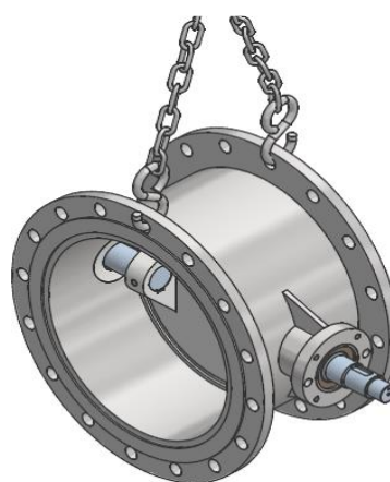
Illustration 4-2 : Fixation aux trous de bride
