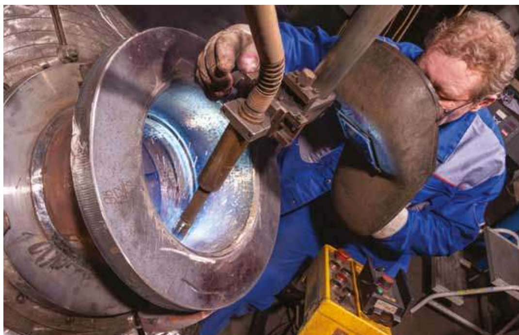
Eine Armatur wird instandgesetzt. Foto: Konrad Armaturentechnik
